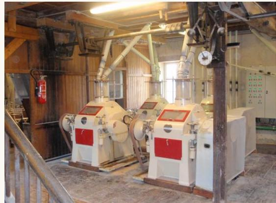
*Au cœur du moulin : plansichester et appareils à cylindres*
